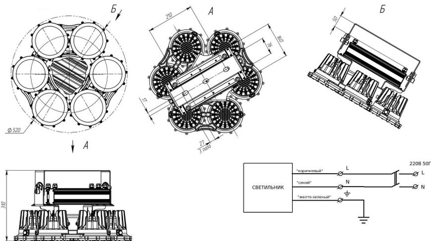
Рисунок 1. Габаритный чертеж.
